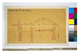
LIIMus.IV, Torbau, Konstruktion des Dachstuhls, Neusch., DI031979, BSV-
